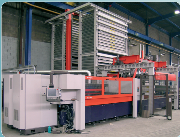
Machine Laser et son magasin de stockage (capacité 40 tonnes de tôle)
