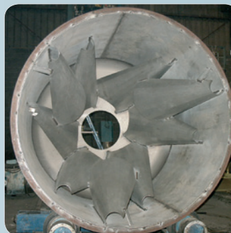
Intérieur d'un mélangeur
