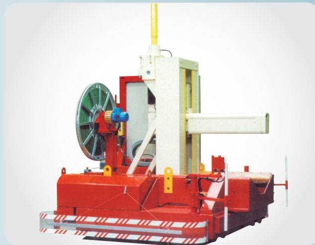
○ Chariot automatique pour le transfert et chargement de bobines d'acier de 11 tonnes. (ARCELOR MITTAL)
