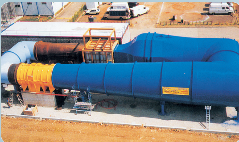
Soufflerie de 104 tonnes pour tester l'aérodynamisme des formules 1 (LIGIER)
