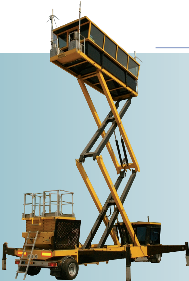
Tour de contrôle aérien mobile avec nacelle d'accès (TWIST)
