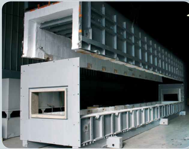
Four industriel avec garnissage en fibres réfractaires (SERMAS).
