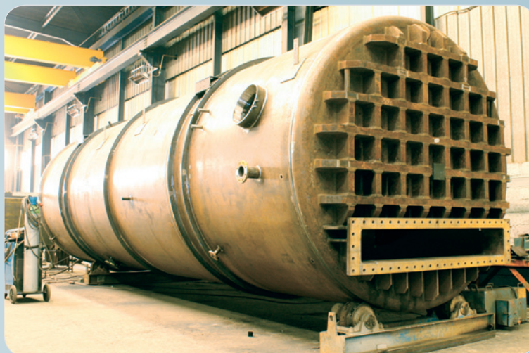
○ Stérilisateur sous pression Ø 2400 mm - volume 70 m³ réceptionné suivant DESP (ACB HYDROLOCK)
